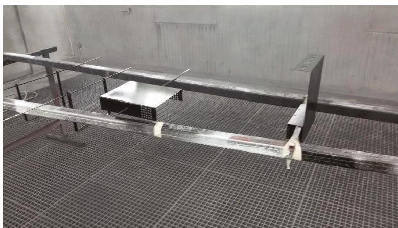
Obr. 4: Výroba hliníkového šasi – lakování
