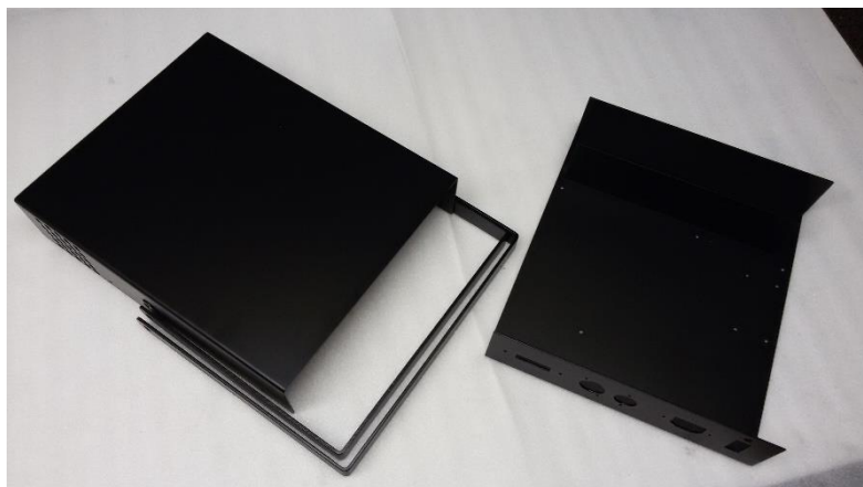
Obr. 5: Výroba hliníkového šasi – finální lak
